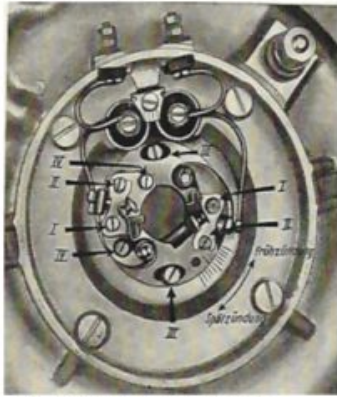
På den såkaldte skrue på platin hammeren bliver den indstillet og den rigtige tænd indstilling findes.
