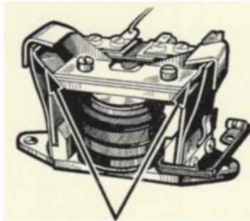
Regulatoren justeres ved stopvinklerne markeret med pile ved hjælp af en speciel nøgle
